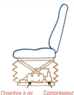
Cette suspension est plus avantageuse qu'une suspension mécanique car elle permet l'automatisation du réglage de poids, soit après action sur une commande, soit par le simple fait de s'asseoir sur le siège. La présence d'une commande permet toutefois à l'opérateur d'affiner le réglage si nécessaire.
